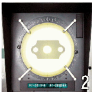
BILD 2 ZEIGT EIN BAUTEIL EINER ANNIETMUTTER UNTER DEM OPTISCHEN KOMPARATOR
