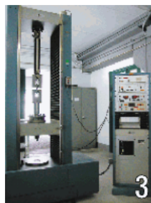
BILD 3 ZEIGT DIE DYNAMISCHE ZUGFESTIGKEITS- TESTMASCHINE MIT DER ELEKTRONISCHEN AUSWERTUNGSEINHEIT
