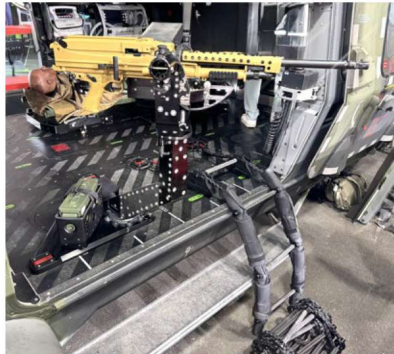
Abbildung 3: Einsatz des hauseigenen Quick Change Systems QCTL® zur schnellen Wechselbefestigung von Equipment im NH90 Helikopter der Bundeswehr (© Verbindungs-Techniken-Rüther GmbH)
